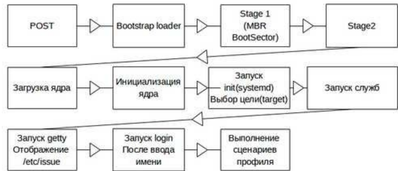
Рисунок 2: Инициализация системы с помощью демона systemd
