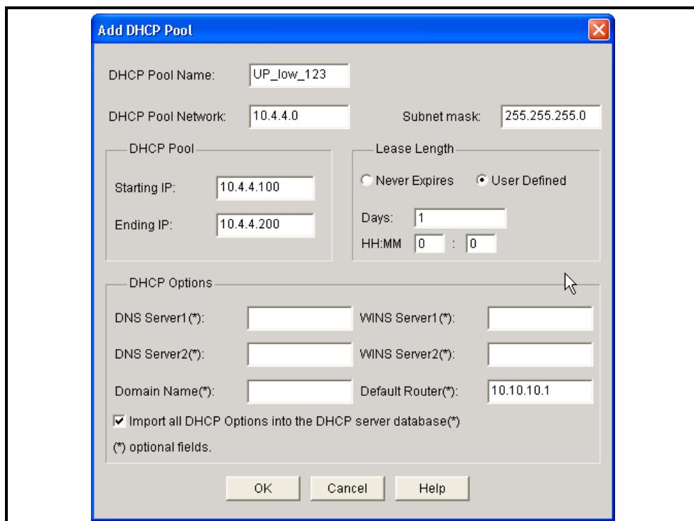
В окне «Add DHCP Pool (Добавить пул DHCP)» можно настраивать пул IP-адресов DHCP. DHCP-сервер присваивает IP-адреса из общего пула, для определения которого задаются начальный и конечный IP-адреса диапазона. В окне «Add DHCP Pool (Добавить пул DHCP)» отображаются следующие поля:
