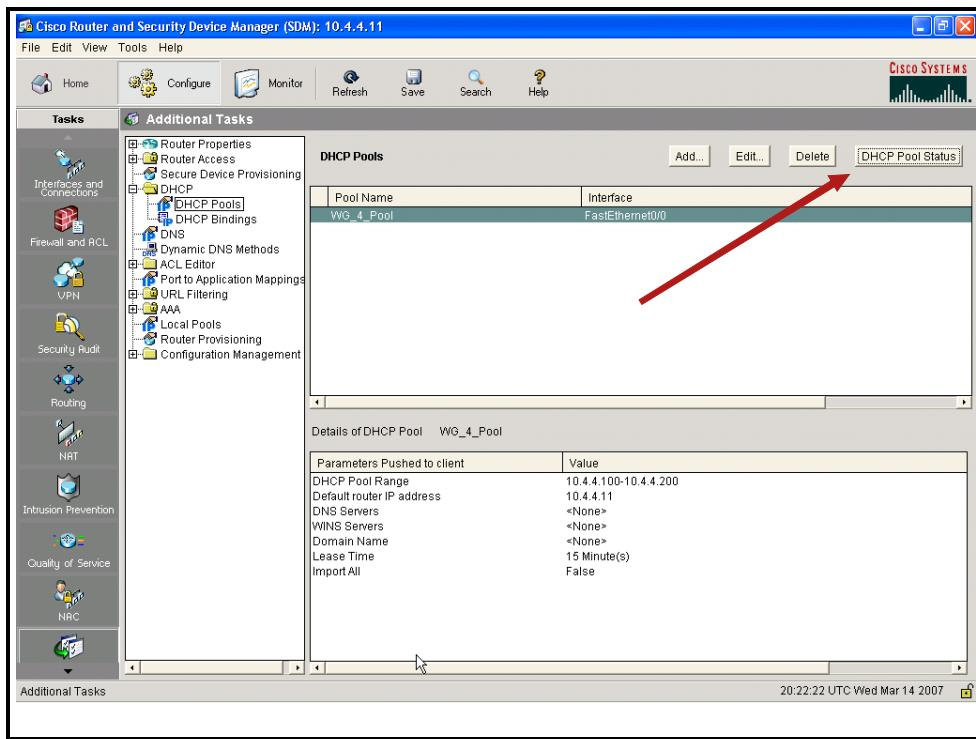
Параметры конфигурации DHCP можно проверить на вкладке «DHCP Pools (Пулы DHCP)». Кроме того, с помощью кнопки **DHCP Pool Status (Состояние пула DHCP)** можно вывести дополнительную информацию об арендуемых адресах.
