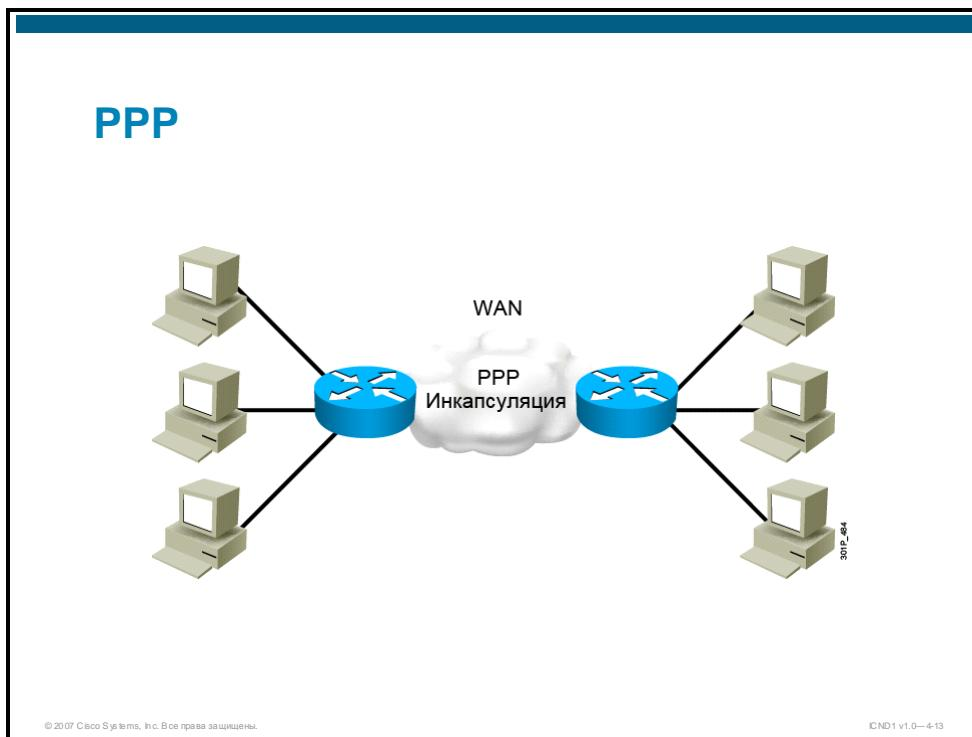
PPP был создан как протокол инкапсуляции, используемый для передачи IP-трафика через каналы «точка-точка». Протокол PPP также определяет стандарт назначения IP-адресов и управления ими, асинхронной (бит начала и остановки передачи) и побитовой синхронной инкапсуляции, мультиплексирования сетевых протоколов, конфигурации канала, проверки качества канала, обнаружения ошибок и согласования параметров для таких функций, как согласование адресов сетевого уровня и сжатия данных.
