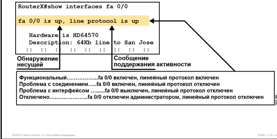
Один из наиболее важных элементов вывода команды **show interfaces** – состояние линии и протокола канального уровня. На рисунке показана ключевая сводная строка для проверки и расшифровки состояния последовательного интерфейса. Для других типов интерфейсов содержание строки состояния может несколько отличаться.
