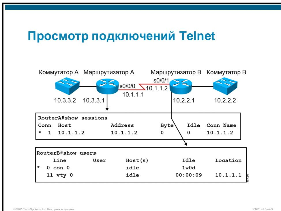
Если на маршрутизаторе установлено программное обеспечение Cisco IOS, для создания Telnet-подключения необходим только IP-адрес или имя хоста конечного устройства. Для создания соединения Telnet с коммутатора Cisco Catalyst используется команда **telnet**, введенная перед IP-адресом или именем хоста конечного устройства.
