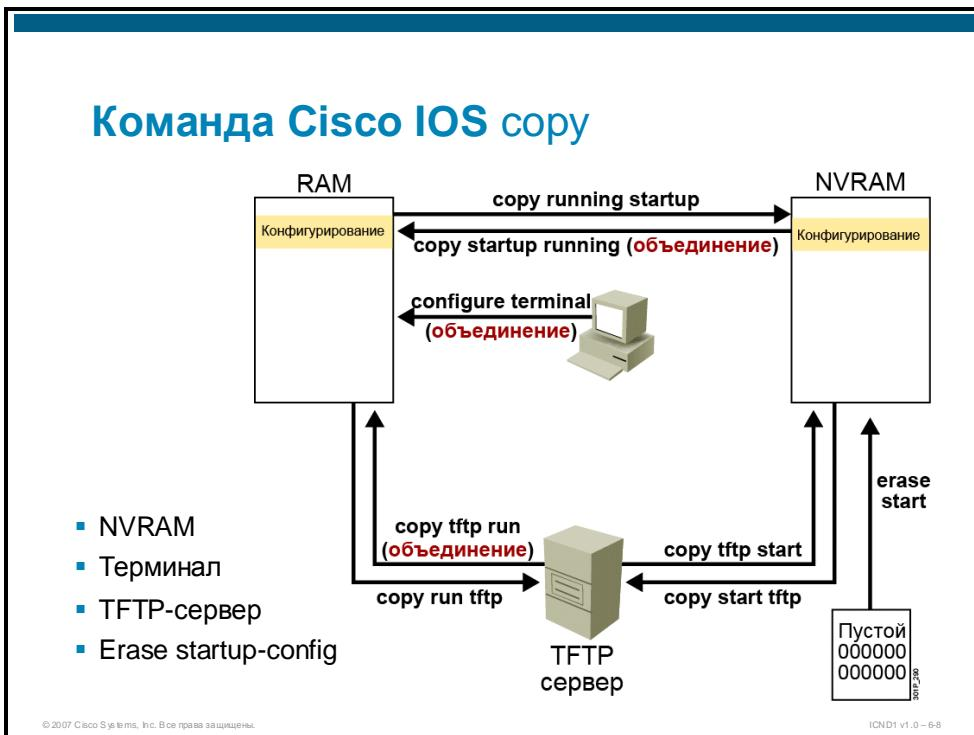
Кроме AutoInstall, программы установки и интерфейса командной строки для загрузки и создания конфигурации можно использовать несколько других источников.
