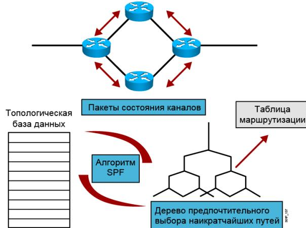
После начальной лавинной рассылки передает небольшие, инициируемые событиями, обновления состояния каналов всем остальным маршрутизаторам
