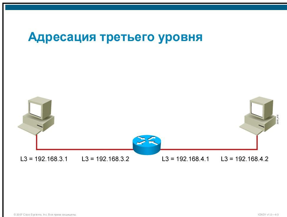
Маршрутизатор имеет отдельный адрес третьего уровня для каждого интерфейса.
