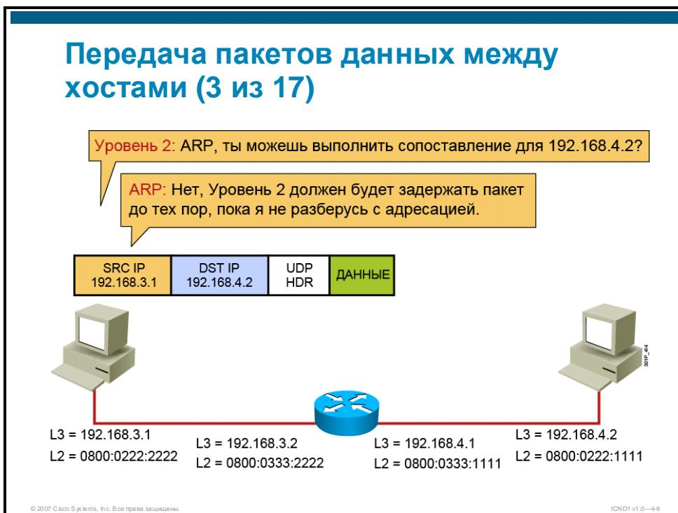
Поскольку установление сеанса связи не требуется, приложение может начать передачу данных. Протокол UDP добавляет в начало пакета заголовок UDP и передает элемент информации протокола (PDU) на уровень IP (третий уровень) с инструкцией отправить этот PDU хосту 192.168.4.2. IP инкапсулирует PDU в пакет третьего уровня и передает его на второй уровень.
