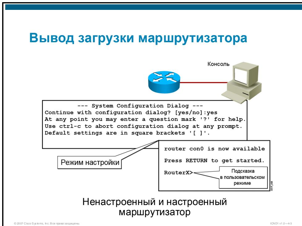
После выполнения процедуры POST и загрузки образа ПО Cisco IOS маршрутизатор ищет файл конфигурации устройства в памяти NVRAM. Память NVRAM маршрутизатора является энергонезависимой, то есть ее содержимое сохраняется даже при отключении питания. Если в памяти NVRAM маршрутизатора найден файл конфигурации, появляется приглашение пользовательского режима. На рисунке показано приглашение RouterX>.
