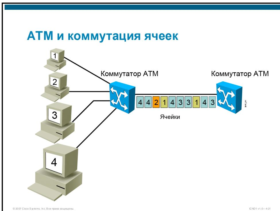
Поставщики сетевых услуг давно нуждались в технологии общих сетей постоянного доступа с низкой задержкой и джиттером и высокой полосой пропускания. Решением стало использование технологии, которая применяется в центральных сетях – ATM. Технология ATM обеспечивает скорости передачи данных выше 155 Мбит/с. Схемы топологии распределенных сетей ATM очень похожи на другие технологии общего доступа, такие как X.25 и Frame Relay.
