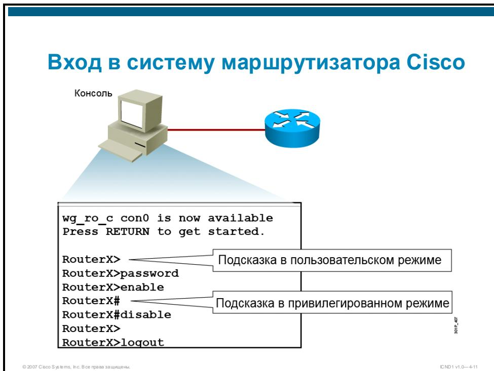
После настройки маршрутизатора Cisco с помощью команды setup можно перенастроить конфигурацию или внести дополнения с помощью интерфейса пользователя, подключившись к консоли маршрутизатора или вспомогательному порту. Кроме того, для настройки маршрутизатора Cisco можно использовать приложение удаленного доступа, например SSH.
