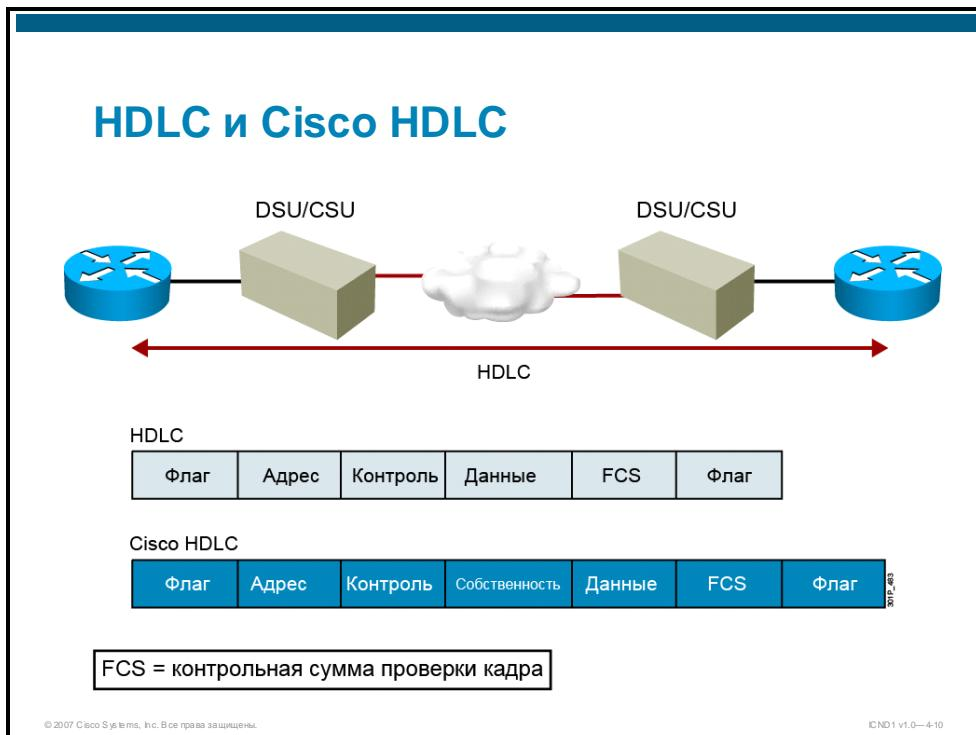
Протокол HDLC определяет метод инкапсуляции данных в каналах синхронной последовательной передачи с использованием кадров и контрольной суммы. Протокол HDLC поддерживает как конфигурацию «точка-точка», так и многоточечные конфигурации, а также аутентификацию. Однако протокол HDLC может стать причиной несовместимости двух устройств различных поставщиков из-за разных способов его реализации.
