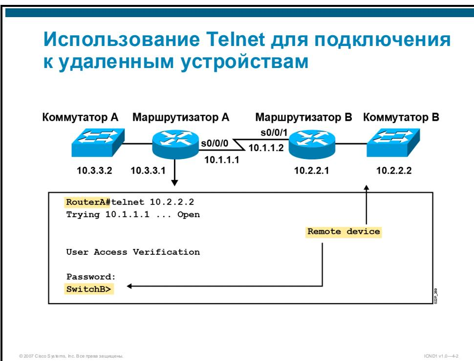
Одним из способов получения информации об удаленном устройстве является подключение к нему с помощью приложений Telnet или SSH. Telnet и SSH являются протоколами виртуального терминала, входящими в стек TCP/IP. Протоколы обеспечивают подключения и сеансы удаленной консоли с одного сетевого устройства к одному или нескольким другим удаленным устройствам.
