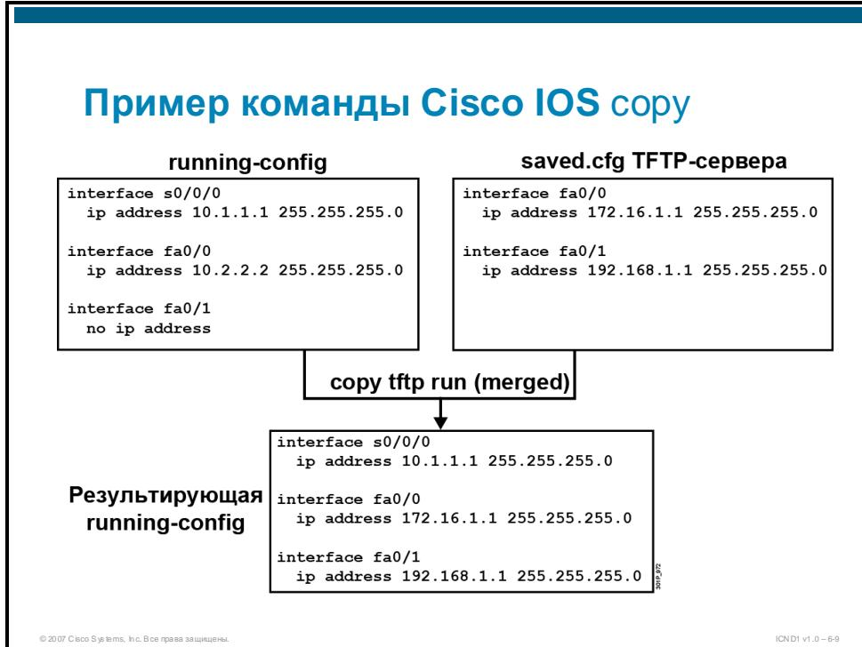
На рисунке показан пример использования команды **copy tftp run** для объединения текущей конфигурации в ОЗУ с файлом конфигурации, сохраненным TFTP-сервере.
