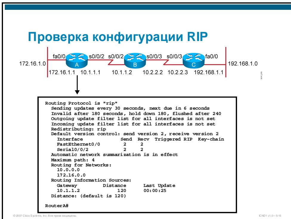
Команда **show ip protocols** отображает параметры протоколов маршрутизации и данные таймеров протокола маршрутизации, связанного с маршрутизатором.
