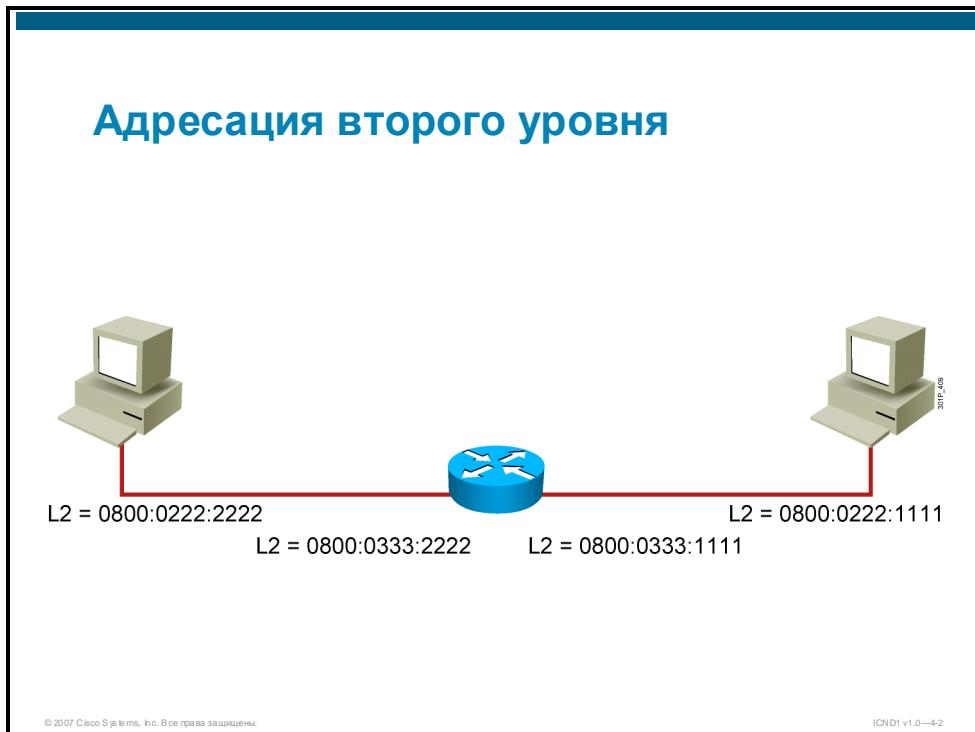
MAC-адреса присваиваются таким конечным устройствам, как хосты. Физические интерфейсы маршрутизатора обеспечивают функции второго уровня, поэтому им назначается MAC-адрес.
