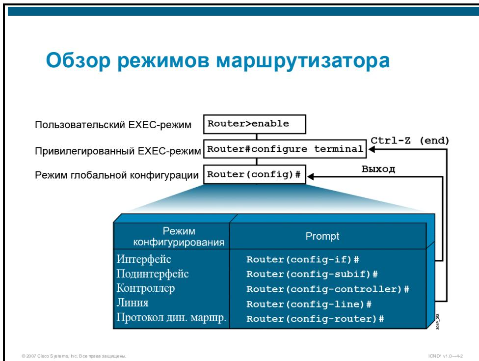
Первый этап настройки маршрутизатора Cisco – использование утилиты установки (setup). Эта утилита позволяет создать базовую начальную конфигурацию. Для создания более сложной специальной конфигурации можно использовать интерфейс командной строки, войдя в конфигурационный режим терминальной сессии.
