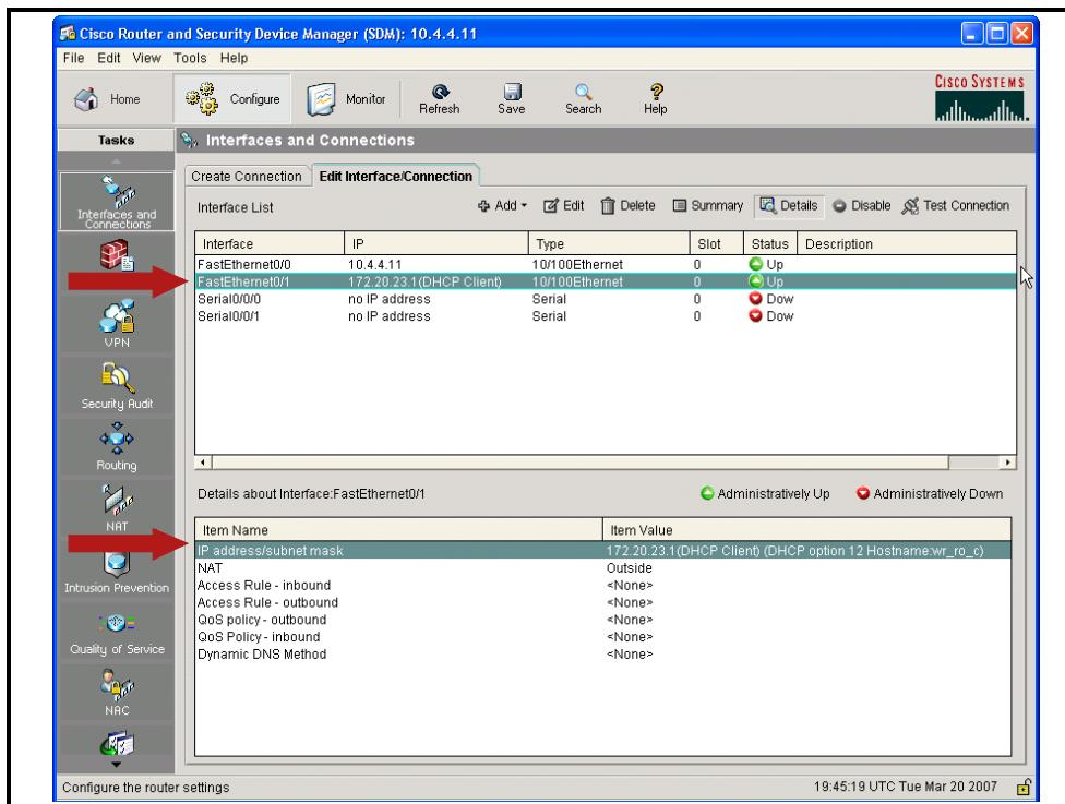
В окне Interfaces and Connections (Интерфейсы и подключения) убедитесь, что DHCP-клиент получает адрес с DHCP-сервера.
