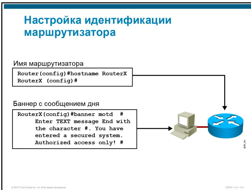
Одна из первых задач конфигурации маршрутизатора заключается в назначении имени. Назначение имен маршрутизаторам помогает улучшить управление сетью, так как они позволяют однозначно определить каждый маршрутизатор в сети. Имя маршрутизатора считается именем хоста. Это имя отображается в приглашении системы. Если имя не задано, по умолчанию используется имя Router. Имя маршрутизатора задается в режиме глобальной конфигурации. В приведенном ниже примере для маршрутизатора задается имя RouterX.
