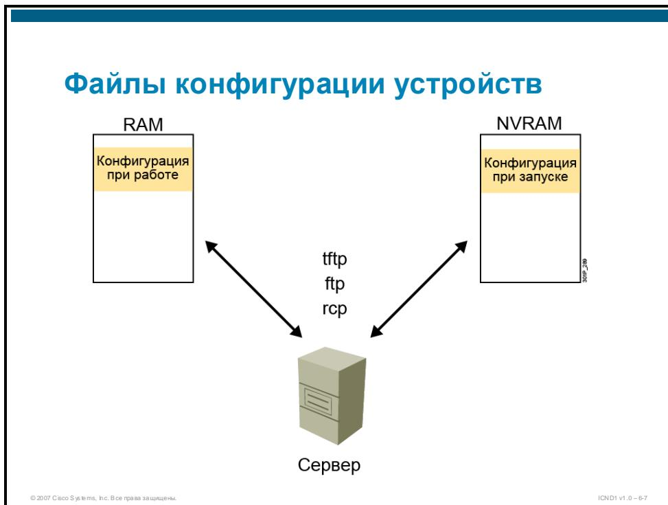
В файлах конфигурации содержатся команды ПО Cisco IOS, используемые для настройки функций маршрутизирующего устройства Cisco, например маршрутизатора, сервера доступа, коммутатора и т. д. При загрузке системы из файла загрузочной конфигурации или при вводе команд в режиме конфигурации интерфейса командной строки выполняется синтаксический разбор команд, т. е., они преобразуются и выполняются программным обеспечением Cisco IOS.
