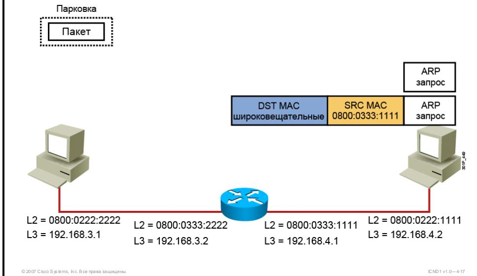
Устройство назначения получает и обрабатывает запрос ARP.
