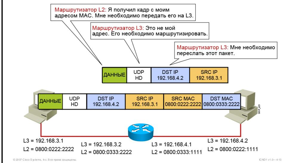
Ожидающий кадр отправляется с использованием IP-адреса и MAC-адреса локального хоста в качестве источника. Однако IP-адрес назначения соответствует удаленному хосту, а MAC-адрес назначения – шлюзу по умолчанию.
