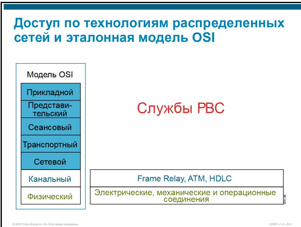
Стандарты доступа по технологиям распределенных сетей описывают способы доставки физического уровня и требования к канальному уровню, включая физическую адресацию, управление потоком и инкапсуляцию. Определение этих стандартов и управление ими возложено на ряд признанных учреждений, таких как ISO, TIA и EIA.
