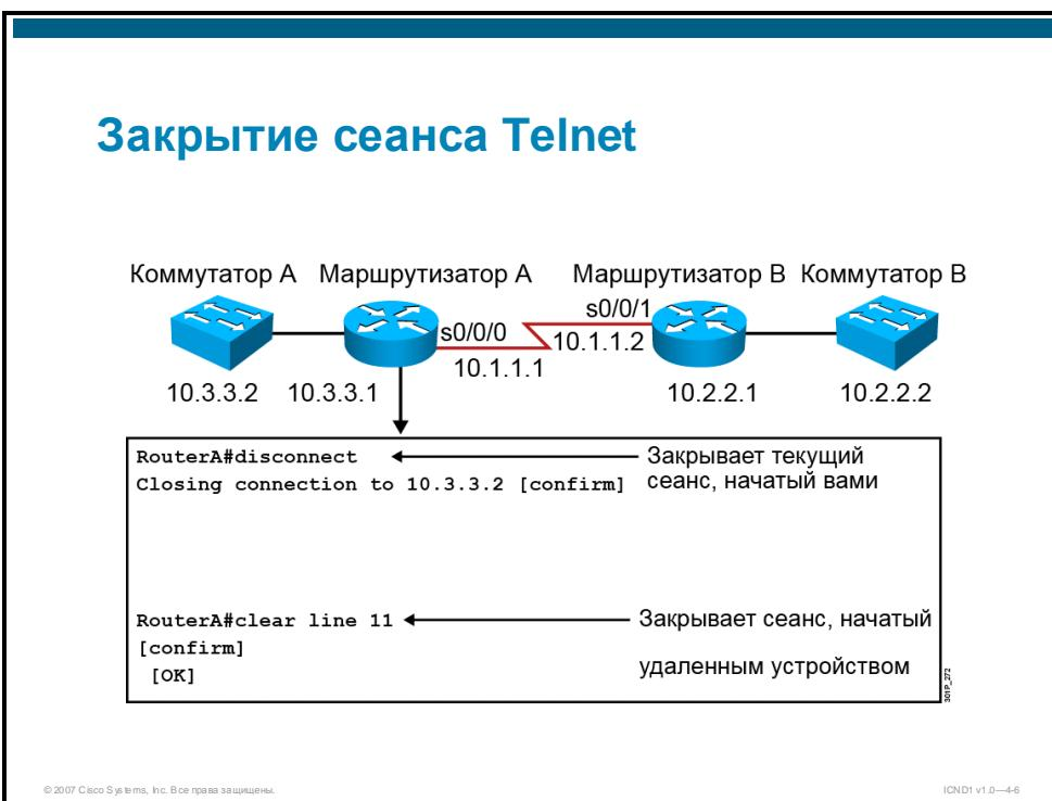
Закрыть сеанс Telnet на сетевом устройстве Cisco можно одним из следующих способов:
