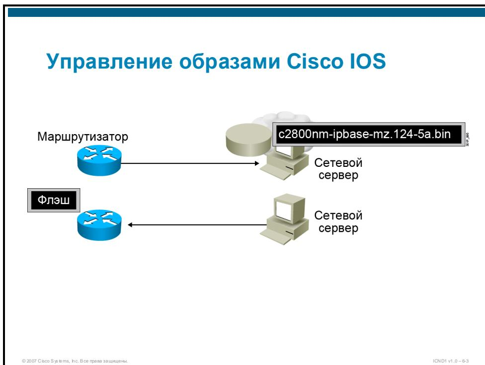
Производственные интерсети обычно занимают обширные области и содержат несколько маршрутизаторов. В любой сети всегда разумно хранить резервную копию образа программного обеспечения Cisco IOS на случай повреждения или случайного удаления системного образа на маршрутизаторе.
