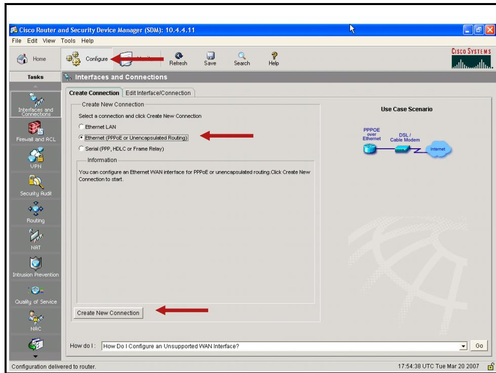
Чтобы начать настройку интерфейса DHCP-клиента, откройте вкладку **Interfaces and Connections** (**Интерфейсы и подключения**). Установите переключатель **Ethernet (PPPoE or Unencapsulated Routing)** (**Ethernet или маршрутизация без инкапсуляции**) и нажмите кнопку **Create New Connection** (**Создать новое подключение**).
