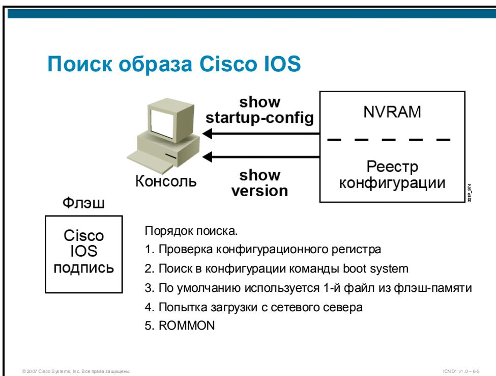
За обнаружение программного обеспечения Cisco IOS отвечает код загрузки. Он выполняет поиск образа в следующей последовательности.
