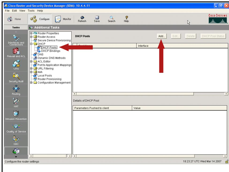
Функция DHCP-сервера включается на вкладке «Additional Task (Дополнительная задача)». Выберите в каталоге элемент **DHCP Pools (Пулы DHCP)**. Затем нажмите кнопку **Add (Добавить)** для создания нового пула DHCP.
