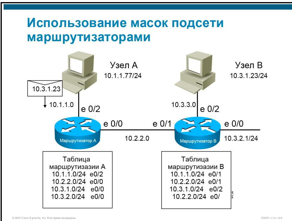
Все маршрутизаторы ведут таблицы маршрутизации. В зависимости от расположения маршрутизатора в иерархии сети эта таблица может быть небольшой и простой или большой и сложной.
