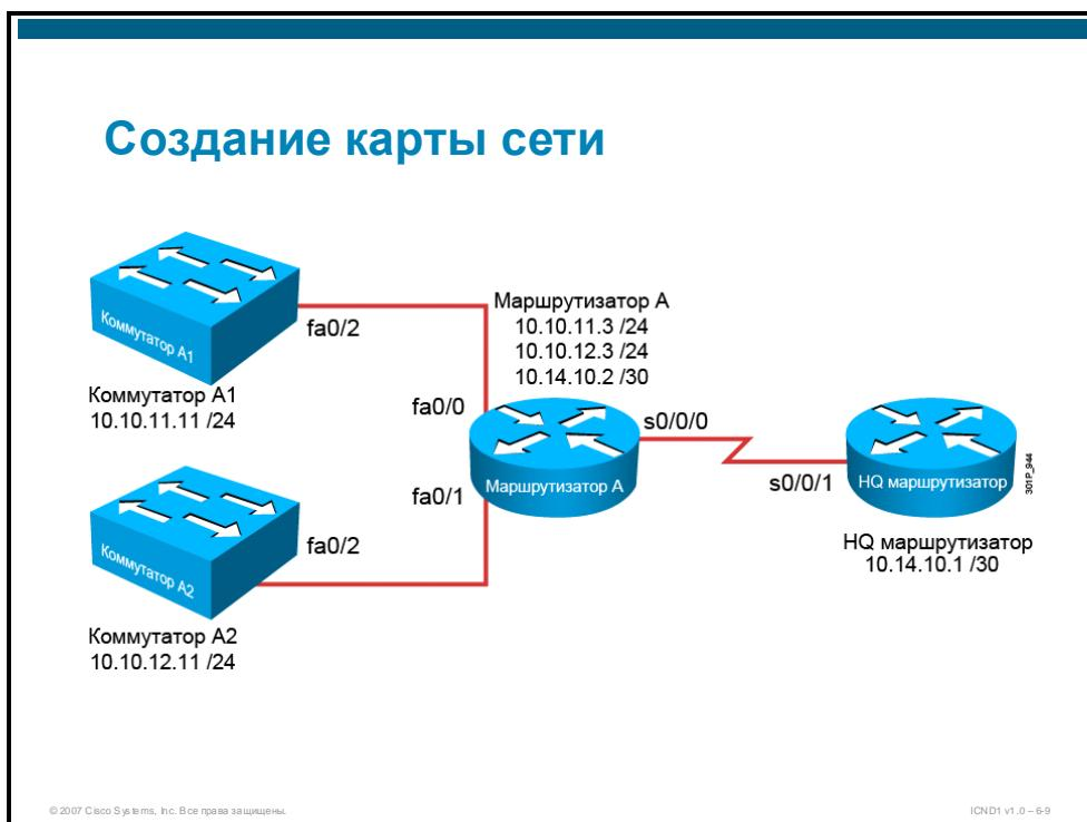
Документация по топологии используется для проверки соответствия проектным рекомендациям, а также для проектирования, изменения и устранения неполадок в будущем. Документация по топологии должна включать как логическую, так и физическую документацию по следующим компонентам:
