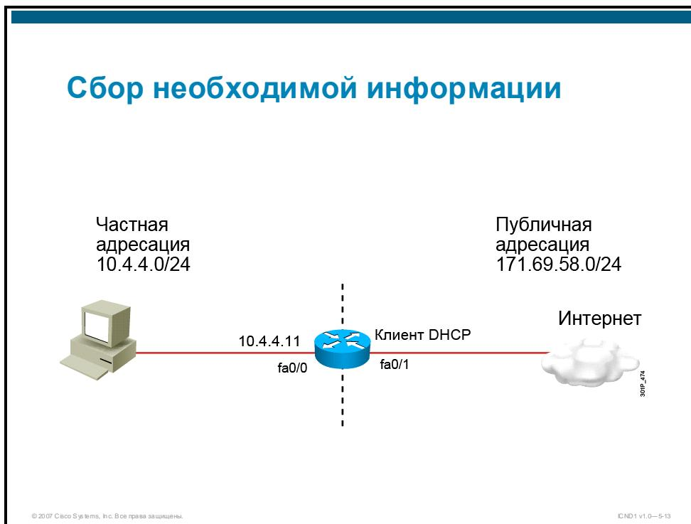
В рассматриваемой среде будет выполнена настройка интерфейса глобальной сети (fa0/1) в качестве DHCP-клиента, ему будет назначен IP-адрес, шлюз по умолчанию и маршрутизация по умолчанию с DHCP-сервера Интернета. Кроме того, для преобразования внутренних частных адресов во внешние общие адреса будет включен механизм PAT.
