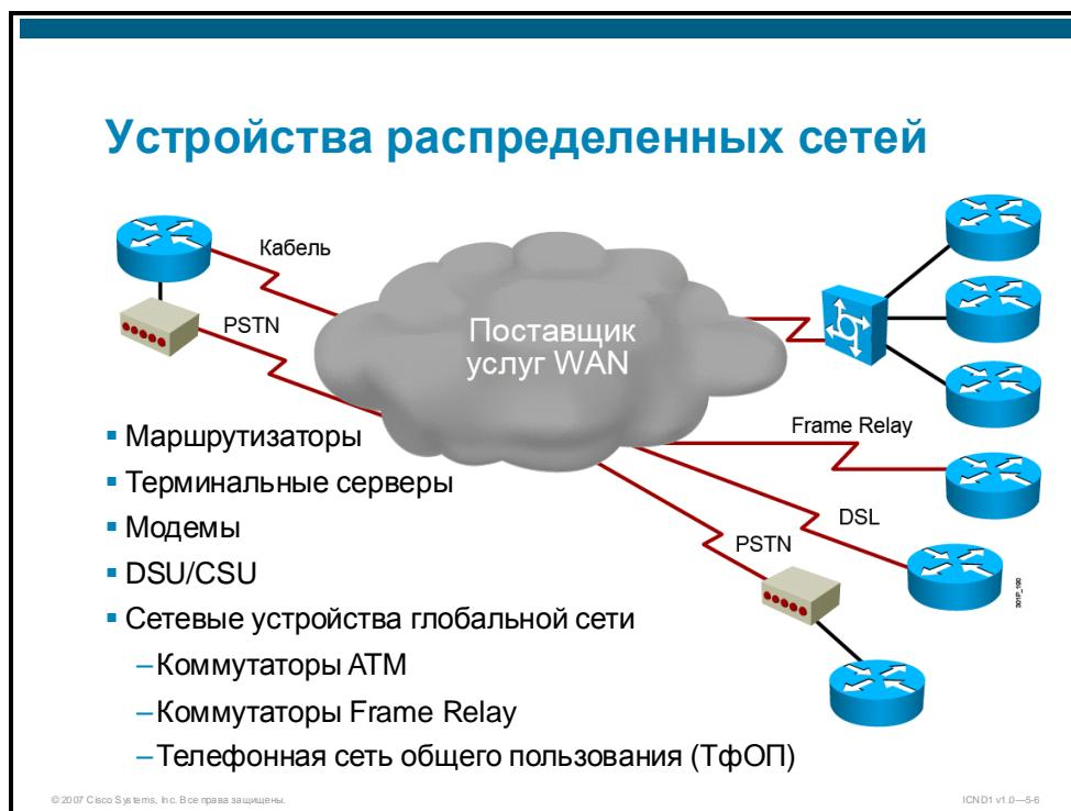
Для доступа по технологиям распределенных сетей используются следующие устройства.
