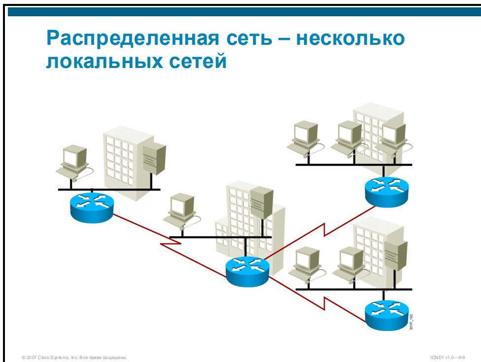
Маршрутизаторы оснащены интерфейсами ЛВС и РВС. Хотя маршрутизаторы используются для сегментации локальных сетей, они также служат коммутационным устройством для доступа к распределенной сети. Чтобы лучше понять функции и роль маршрутизатора в предоставлении доступа к распределенной сети, рассмотрим типы доступных соединений на маршрутизаторе.
