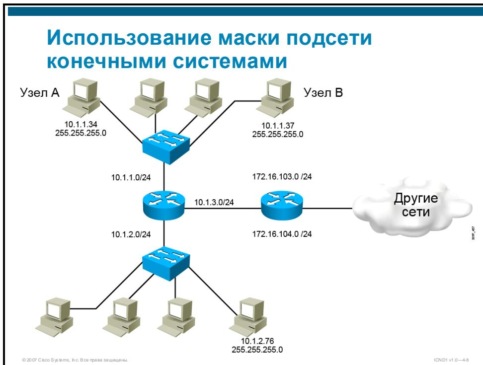
Перед тем, как конечная система отправит пакет по месту назначения, она должна определить, относится ли этот адрес назначения к данной локальной сети. Если относится, конечная система будет использовать процесс Address Resolution Protocol (ARP) для привязки IP-адреса к MAC-адресу. В противном случае пакет должен пересыпаться маршрутизатору, используемому в качестве шлюза по умолчанию, для передачи в сеть назначения.
