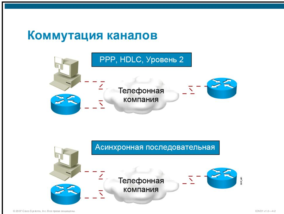
При коммутации каналов для каждого сеанса связи устанавливается, поддерживается и закрывается выделенный путь по сети оператора. Только путь доступа является выделенным физическим каналом, сеть использует те или иные технологии мультиплексирования внутри распределенной сети.
