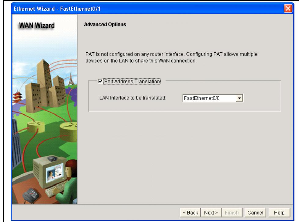
Установите флажок **Port Address Translation** (Преобразование адресов портов) и выберите внутренний интерфейс из раскрывающегося списка.
