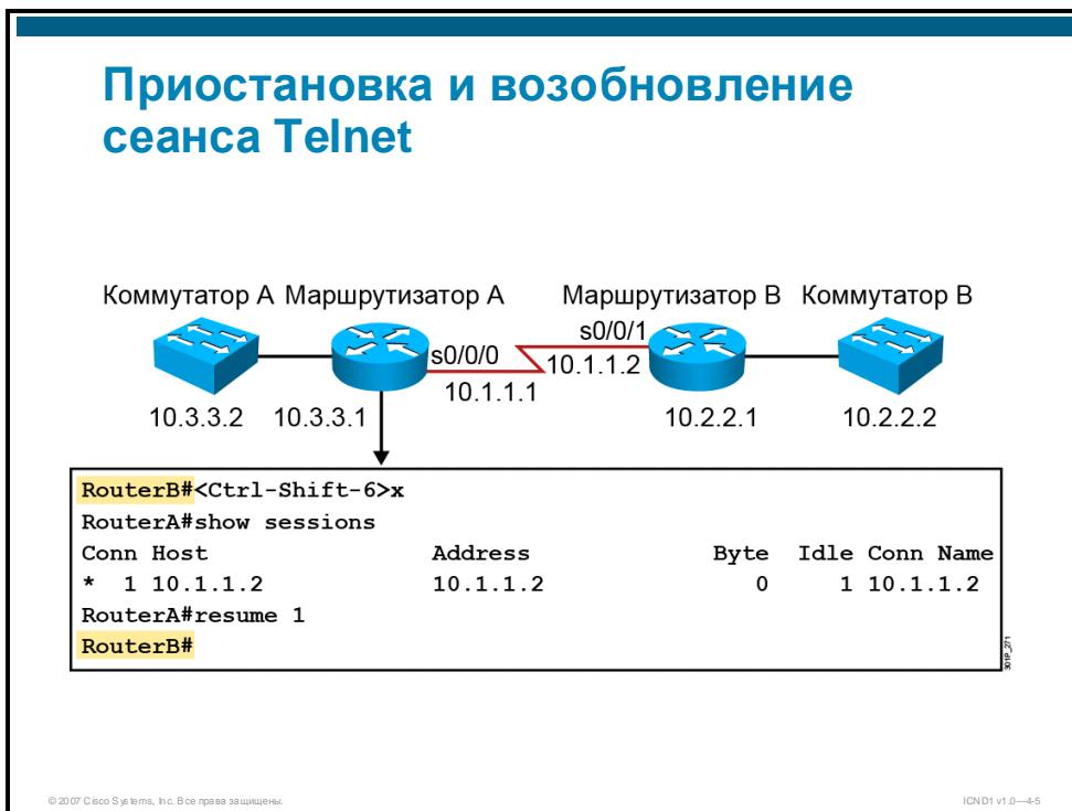
На рисунке показан сеанс Telnet с маршрутизаторе А к маршрутизатору В. Для приостановки сеанса необходимо нажать указанную последовательность клавиш. Приглашение локальной системы свидетельствует о том, что сеанс Telnet приостановлен.
