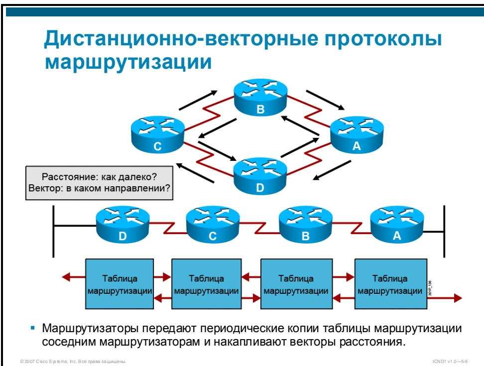
Периодические обновления данных маршрутизации большинства дистанционно-векторных протоколов маршрутизации направляются только маршрутизаторам с прямым подключением. В качестве схемы адресации используется логическая широковещательная рассылка. Маршрутизаторы под управлением дистанционно-векторных протоколов рассылают периодические обновления, даже если в сеть не вносились изменения.
