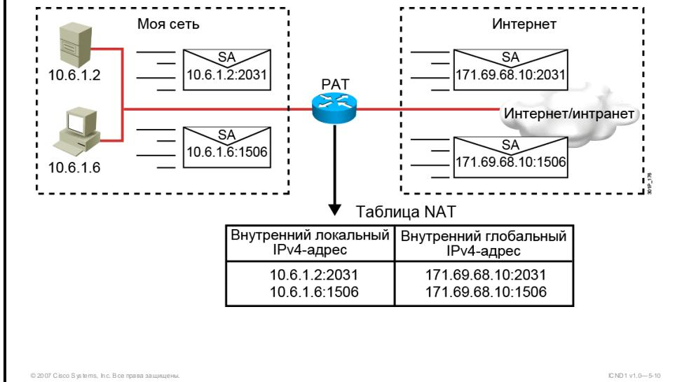
Одна из главных функций NAT – статическое преобразование PAT, которое также называется «перегрузкой» в конфигурации Cisco IOS. Несколько внутренних адресов могут быть преобразованы с помощью NAT в один внешний адрес или в небольшое их количество с использованием PAT.
