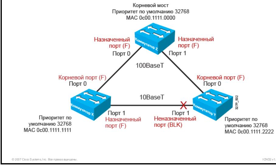
При изменении топологии из-за отказа моста или канала протокола "spanning tree" перенастраивает топологию сети для сохранения соединений, переводя заблокированные порты режим пересылки.
