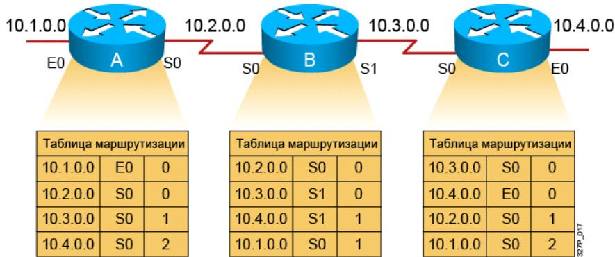
На каждом узле ведутся записи о расстоянии от этого узла до всех возможных сетей назначения.
