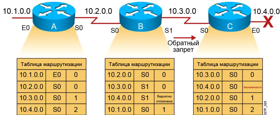
Функция Poison reverse переопределяет метод Split horizon.
