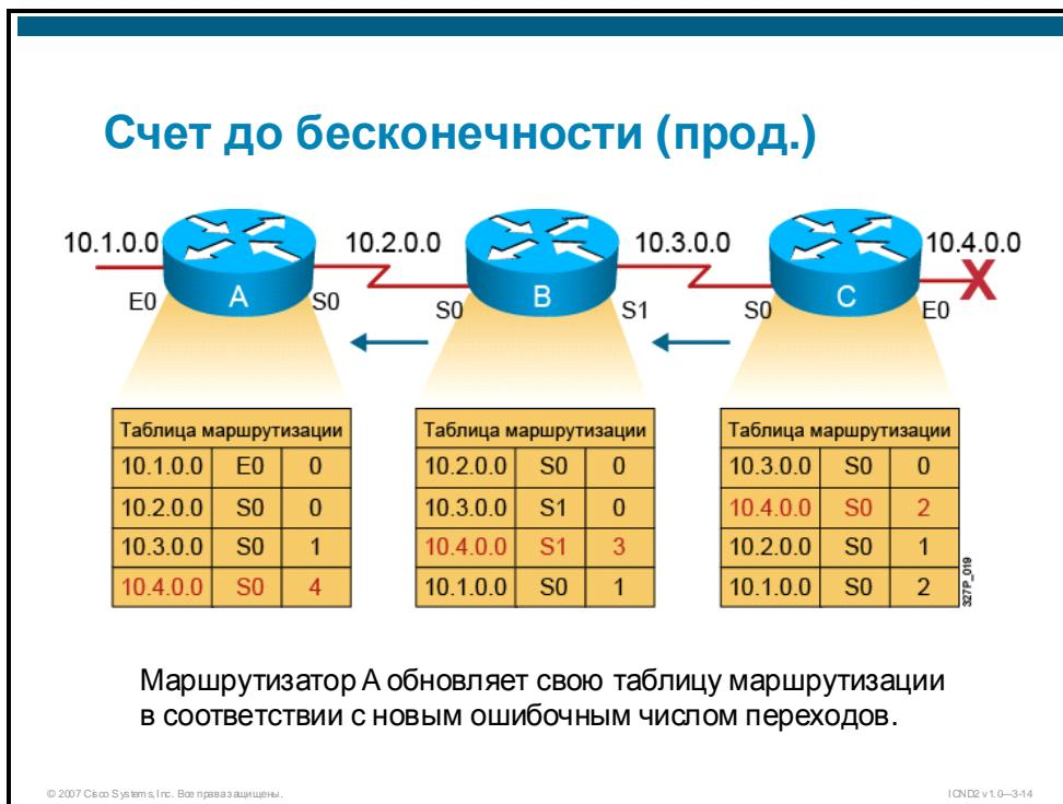
Маршрутизатор В получает новое обновление от маршрутизатора С и обновляет свою таблицу, добавляя новую стоимость (3 перехода). Маршрутизатор А получает новую таблицу маршрутизации от маршрутизатора В, обнаруживает обновленный вектор расстояния к сети 10.4.0.0 и перерассчитывает свой собственный вектор расстояния до 10.4.0.0. Новое значение равняется 4.
