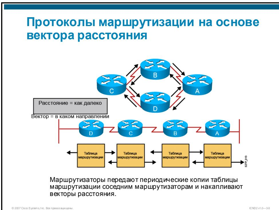
Периодические обновления данных маршрутизации большинства протоколов маршрутизации на основе векторов расстояния направляются только маршрутизаторам с прямым подключением. В качестве схемы адресации используется логическая широковещательная рассылка. Маршрутизаторы под управлением протоколов на основе векторов расстояния рассылают периодические обновления, даже если в сеть не вносились изменения.
