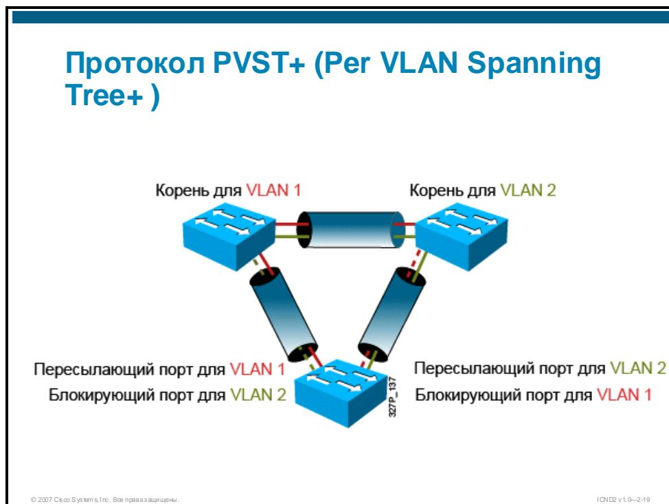
Стандарт 802.1D определяет протокол Common Spanning Tree (CST), который разрешает только один экземпляр протокола "spanning tree" на коммутируемую сеть, независимо от количества VLAN. В сети под управлением CST справедливы следующие утверждения:
