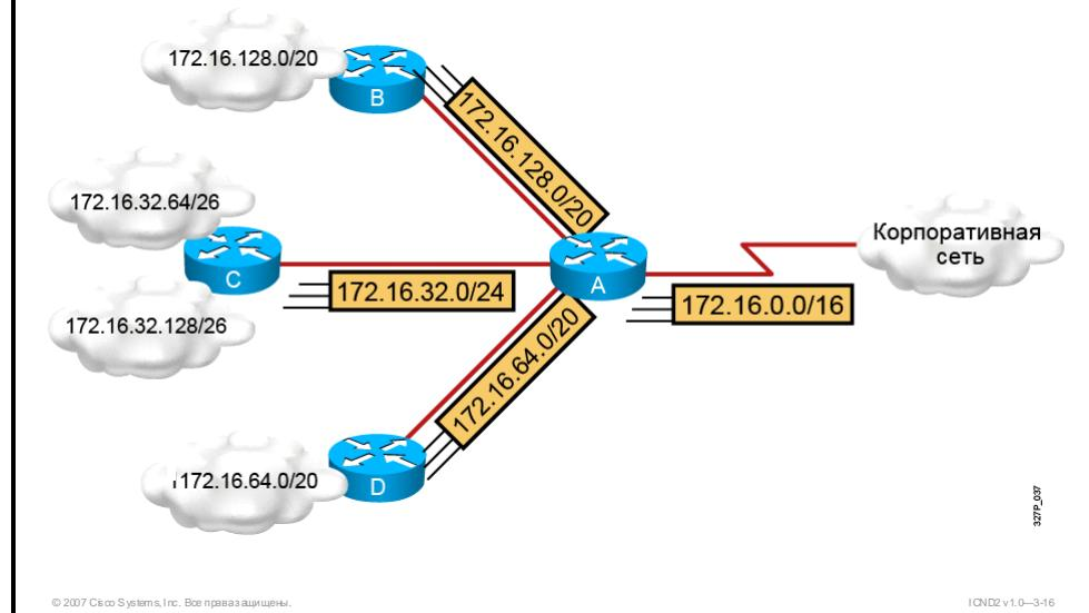
Чтобы маршрутизатор мог объединить максимальное число IP-адресов в один суммированный маршрут, план IP-адресации должен быть иерархическим. Этот подход особенно важен при использовании VLSM. При использовании IP-адресации архитектура VLSM обеспечивает максимальное использование IP-адресов и более эффективное обновление маршрутизации.
