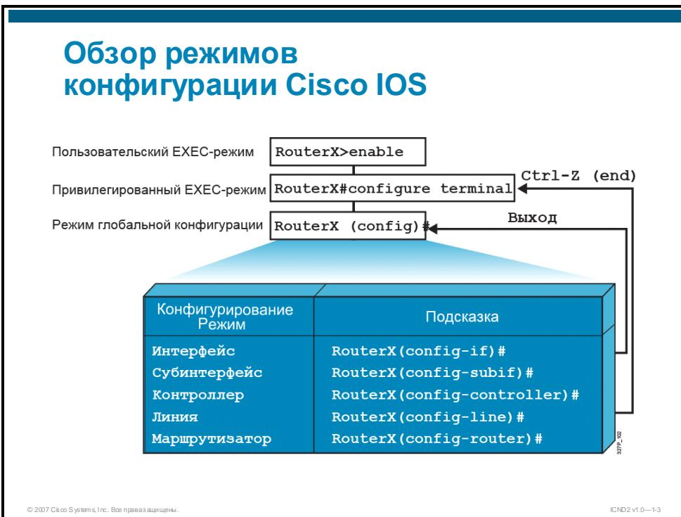
Первый метод конфигурации устройства Cisco — утилита установки, которая позволяет создать базовую начальную конфигурацию. Для создания более сложных и специализированных конфигураций используйте интерфейс командной строки, чтобы войти в режим конфигурации терминала.
