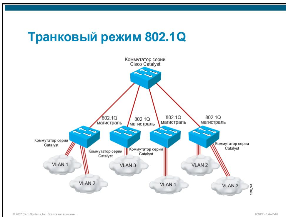
Транковое подключение — это канал «точка-точка» между одним или несколькими Ethernet-интерфейсами коммутатора и другим сетевым устройством, например маршрутизатором или коммутатором. Транковое подключение Ethernet используются для передачи трафика из нескольких сетей VLAN через один канал и позволяет расширять VLAN на всю сеть. Cisco поддерживает протокол IEEE 802.1Q для интерфейсов Fast Ethernet и Gigabit Ethernet.
